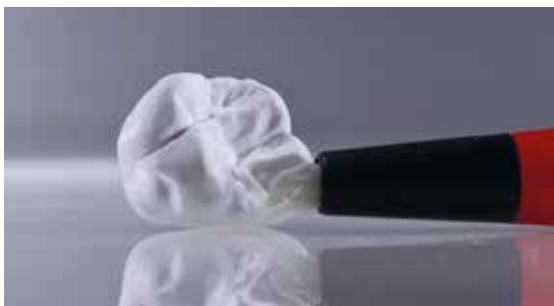
Eliminare accuratamente la polvere di ossido di zirconio con un pennello morbido e quindi pulire con getto d'aria compressa priva di olio.
