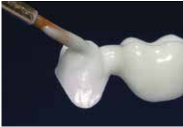
Applicare IPS e.max ZirLiner ed effettuare la cottura
