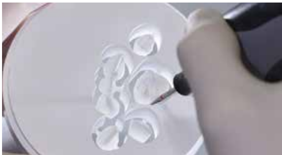
Separazione dei restauri con frese in metallo duro o con strumenti per rifinitura diamantati. Si consiglia di intaccare le barre di tenuta da un lato prima di separare completamente il restauro.
