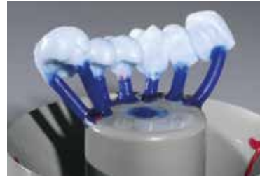
Impernatura e messa in rivestimento del restauro
